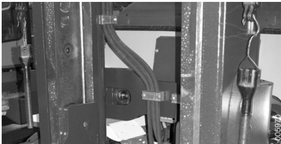
4. Fixez le chariot de levage sur une traverse et faites avancer la machine vers le chariot de levage ou mettez le chariot de levage en place contre la colonne importante.
